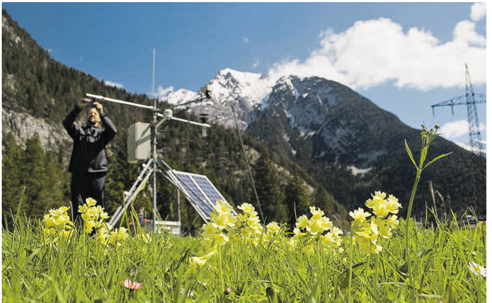
Spezialgeräte messen hier 20 Mal pro Sekunde die Zusammensetzung kleinster Luftpakete und Kohlendioxidflüsse über der Wiese.
